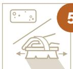
Qualora dopo il trattamento di pulitura fosse necessario schiarire il teak oppure eliminare il colore grigio-nerastro dovuto all'invecchiamento, **distribuisce** sul legno ancora bagnato con acqua dolce **T-BLEACHING** in maniera uniforme su tutta la superficie con una **spazzola morbida** o una **spugna**.
